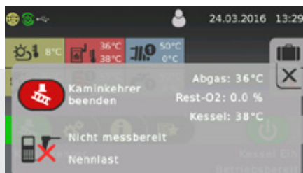
Abb. 2 Ansicht der Kaminkehrerfunktion
